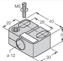
Befestigungsschelle für Gewinderohrsensoren, mit Festanschlag; Werkstoff: PA6
