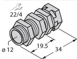
Schnellmontagehalterung mit Festanschlag; Werkstoff: Messing verchromt. Außengewinde M16 x 1. Hinweis: Der Schaltabstand der Näherungsschalter kann sich durch Verwendung von Schnellmontagehalterungen ändern
