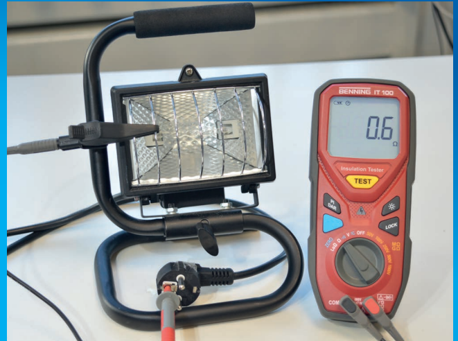
Widerstandsmessung zur Prüfung des Schutzleiters
