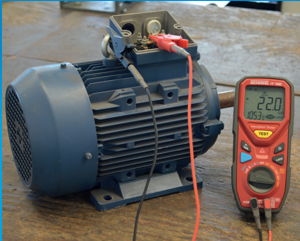
Messung des Isolationswiderstandes mit 1000 V
