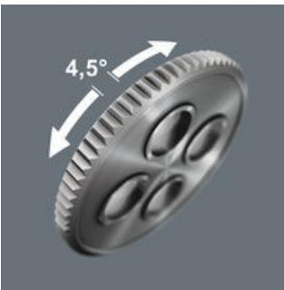
Die integrierte Ratsche mit Feinverzahnung (80 Zähne) und einem Rückholwinkel von 4,5° vereinfacht und beschleunigt das Schrauben ohne mühsames Neuansetzen.
