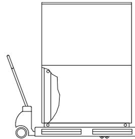
Zur Nutzung der Transportbohrungen im Rahmen ist es notwendig, die unteren Fassadierungsteile abzunehmen. Dazu werden jeweils zwei Schrauben am Sockel gelöst und die Bleche durch Zurückziehen oben ausgehängt. Beim Einhängen der Blechteile sollten diese mit leichtem Druck nach oben geschoben werden.
