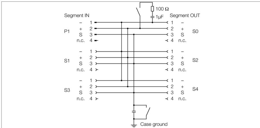
Der vierkanalige Verteilerbaustein vom Typ JBBS-49-E413/3G ist für den FOUNDATION™ fieldbus ausgelegt.
