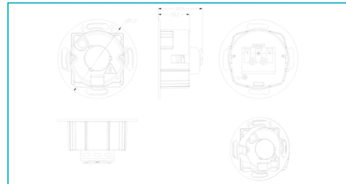
Die Wandeinbauleuchte ALWAID 2 passt durch ihre kompakte Bauform in alle 68 mm Schalterdosen mit normaler und tiefer Bauform. Außerdem benötigt sie kein zusätzliches Netzteil. Mit ihren zahlreichen Abdeckungen fügt sie sich sicher in ihre Umgebung ein und präsentiert ein schönes indirektes Licht. Bei dem Artikel handelt es sich nur um die Base, Abdeckungen sind im Lieferumfang nicht enthalten!
