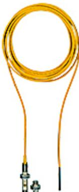
Sicherheitssensor zur Stellungsüberwachung beweglicher Schutzeinrichtungen nach EN 60947-5-3, 2 n/o, 1 Hilfskontakt n/o, LED, mit 10 m Kabel, für Anwendungen bis SIL 3/PL e/Kat. 4, zylindrische Bauform M12, IP69, VP = 1 Sensor mit M12 Betätigter, Schaltabstand 8 mm, Edelstahl Gehäuse, ATEX Zulassung.
