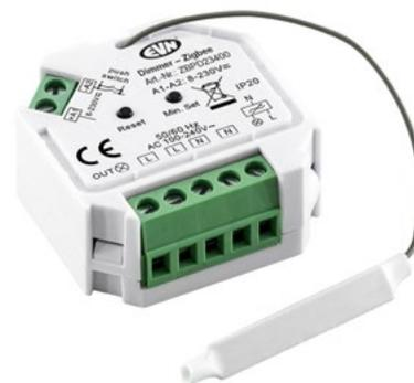
Der Zigbee Dimm-Aktor kann über verschiedene Zigbee-Steuerelemente, aber auch über einen Taster (8V bis 230V/AC/DC) angesteuert werden. Da es sich um einen ZigBee 3.0 Schaltaktor handelt sind viele Geräte kompatibel, unter anderem z. B. Amazon Echo Plus oder das Philips HUE-Gateway. Somit können unterschiedliche Verbraucher bequem über Funk gedimmt und geschaltet werden. Die maximale Leistung beträgt 200W für LED-Verbraucher sowie NV-Halogenleuchtmittel und 400W für HV-Halogenleuchtmittel.
