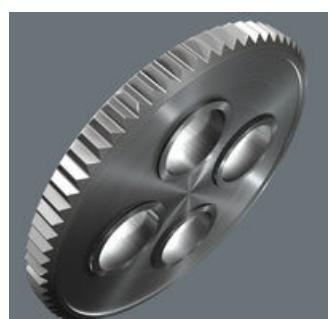
Feinahnmechanik mit 60 Zähnen ermöglicht einen kleinen Rückholwinkel von 6° für präzises Arbeiten.
