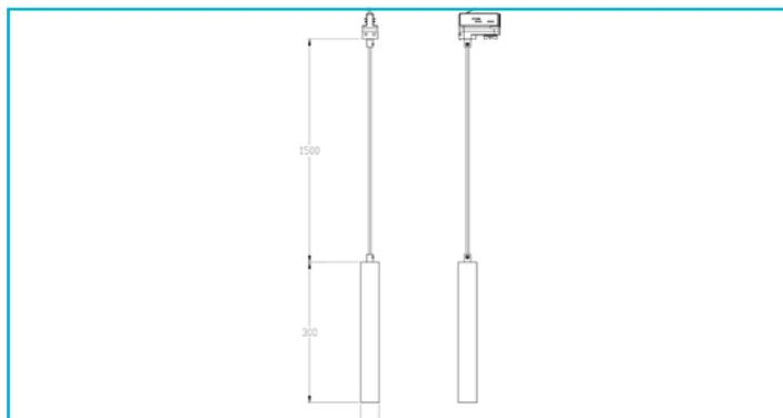
Für das Stromschienensystem gibt es passende Pendelleuchten der SLIM - Serie. Der Leuchtenkorpus aus Aluminium Druckguss ist dabei immer gleich groß [300 x 39mm]. Die Pendelleuchten für die Stromschienen ermöglichen eine Abhängung von maximal 180 cm.
