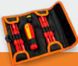
Für Arbeiten im Bereich von spannungsführenden Teilen bis 1000 VAC. VDE & GS-geprüft. Direkt auf den Bit gespritzte Schutzisolation, die im vorderen Bereich vollständig in den Bit integriert ist. Bitaufnahme: Isolierter Clicfix Bithalter aus Metall verriegelt alle Slimbits zuverlässig.
