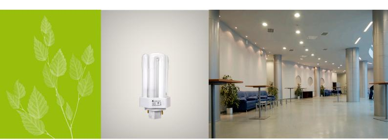
Wirtschaftliche Kompaktleuchtstofflampe in Dreirohr-Technik für Einsatz in kompakten Leuchten, z.B. Ein- und Aufbau-Downlights. Die 2-Pin Ausführung (-T) ist für den Betrieb am VVG, die 4-Pin Ausführung (-TE) für den am EVG geeignet. Die 4-Pin-Ausführung kann auch für den Notstrombetrieb (DC) verwendet werden.
