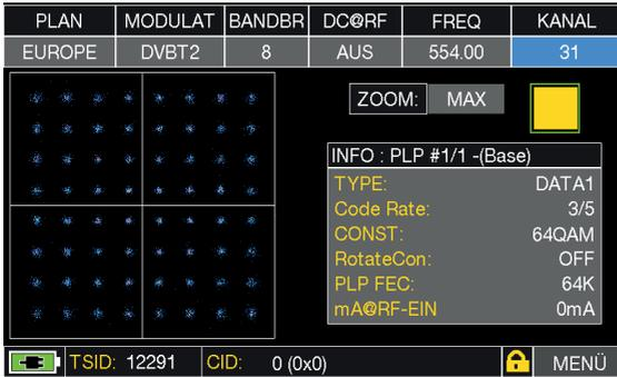
⇒ Der zweite Messbildschirm enthält das Konstellationsdiagramm und Informationen mit Bezug zu den Modulationsparametern: Coderate, FEC, Konstellationsart usw. Über die **ZOOM**-Funktion ist es möglich, die Konstellation zu vergrößern und in vier Quadranten unterzuteilen, um die Diagrammpunkte besser zu analysieren und die TPS-Träger anzuzeigen.
