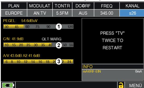
Der HF-Bildträgerpegel ①, das Träger-Geräusch-Verhältnis ② und das Tonträger-/Bildverhältnis ③ werden angezeigt. Bei Stereo-Audio wird auch das A/V-Verhältnis für den zweiten Tonträger angezeigt. Auf diesem zweiten Bildschirm ist keine Video- und Audiodekodierung verfügbar, da der Messempfänger die verschiedenen Signalkomponenten messen soll.
