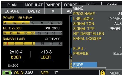
Der Kanallogger ermöglicht die Visualisierung und Aufzeichnung von HF-Messungen für den eingestellten Kanal. Je nach eingestellter Zeitspanne (von 30 Minuten bis sieben Tage) kann die Diagrammaktualisierungsrate variieren. Die Loggerdaten können auch auf einem an den USB-A-Anschluss auf der Gehäuseoberseite angeschlossenen externen USB-Laufwerk gespeichert werden. Nach dem Anschließen des USB-Geräts können der Dateiname über das Kontextmenü definiert und die Messungen protokolliert werden:
