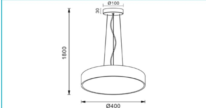
Die Pendelleuchten der MENKAR - Serie überzeugen mit cleveren Beleuchtungsfunktionen und hochwertigem Aluminium-Akzenten. Das separat schaltbare Rücklicht (ca. 15 - 20 % indirekter Lichtanteil) ermöglicht eine dauerhafte indirekte Beleuchtung, während das Hauptlicht jederzeit zugeschaltet werden kann.
