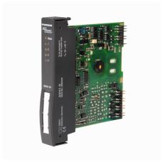
Das Eingangsmodul AIH41-N dient zum Anschluss von 4-Leiter-Messumformern (passiver Eingang = nicht speisend / Geber aktiv).
