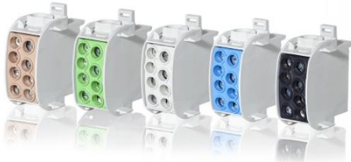
HLAK3p35br; Hauptleitungsabzweigklemme, 3-polig, 35 mm<sup>2</sup> ("L"); Zugang 6 x 35 mm<sup>2</sup>, Abgang 6 x 25 mm<sup>2</sup>; Anschlüsse zertifiziert nach DIN VDE 0603-2; Mit Schnappbefestigung für waagerechte Montage
