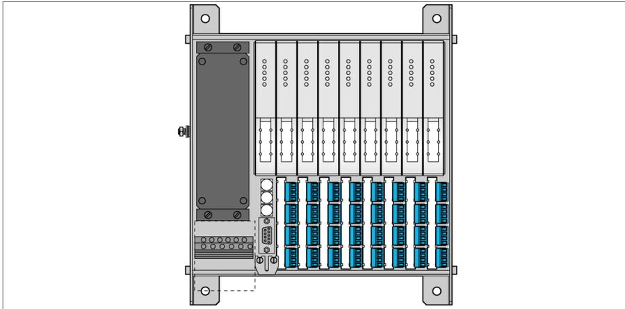
Der Modulträger MT08-2G besteht aus einer Backplane und dem eigentlichen Trägersystem. Er dient zur Aufnahme von einem Gateway, einem Netzteil sowie 8 E/A-Modulen. Es können so bis zu 64 binäre Ein-/Ausgänge oder 32 analoge Ein-/Ausgänge bzw. jede Mischform an den Modulträger angeschlossen werden. Im Gegensatz zu dem MT16 können bei dem MT08 weder Gateways noch Netzteile redundant aufgebaut werden.
