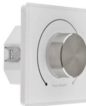
Bei dem Funk-Dimmer-Wandpanel handelt es sich um ein 1-Kanal Druck-Dreh-Panel. Die eingelernten Empfänger bzw. daran angeschlossenen Verbraucher können somit auf- und abgedimmt, sowie ein- und ausgeschaltet werden. Es können sowohl mehrere Empfänger auf ein Wandpanel, als auch mehrere Wandpanel auf einen Empfänger eingelernt werden. Das Panel kann mit einer Spannung von 100-240V/AC betrieben werden. Das Panel kann auch auf tiefe Schalterdosen montiert werden.
