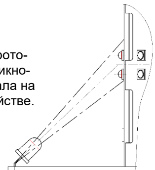
Шаблон 2 для 4 проходящих сверху сквозных болтов
