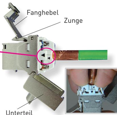
Unterteil des Moduls über das Kabel schieben.
