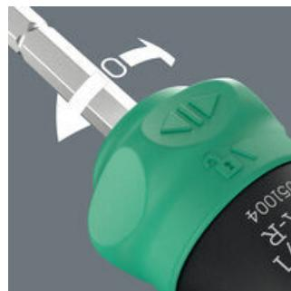
Intuitives Umschalten der Ratschenmechanik. Wird der Drehschalter nach rechts geschaltet, ist die Schraubrichtung rechts; wird er nach links geschaltet, ist die Schraubrichtung links. Mit der 0-Position kann die Ratschenmechanik für präzise Arbeiten deaktiviert werden.
