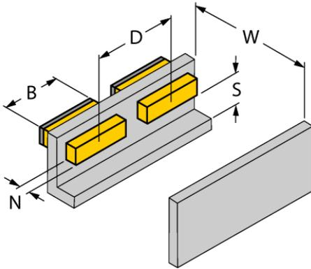
Der Sensor kann an den beiden langen Seiten bündig in Metall eingebaut werden.
