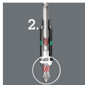
Größere Belastungsspitzen werden durch die Torsionswirkung des Bitschaftes minimiert (Phase 2). Diese Wirkung wird durch eine gezielte Sonderwärmbehandlung nach dem Härteprozess des Bits erzielt. Dadurch wird die Härte des Schaftes gegenüber der Abtriebsspitze reduziert.
