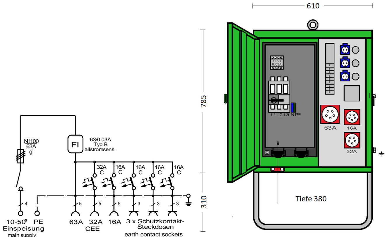
**ELEKTRA** - Verteilerschrank im Gehäuse aus verzinktem Stahlblech, pulverbeschichtet RAL 6018, bestückt mit:
