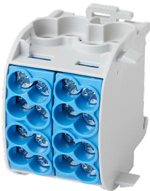
HLAK1p25DbI; Hauptleitungsabzweigklemme, 1-polig, 25 mm<sup>2</sup>/Doppelblock ("L"); Zugang 4 x 16 mm<sup>2</sup>, Abgang 4 x 25 mm<sup>2</sup>; Anschlüsse zertifiziert nach DIN VDE 0603-2; Mit Schnappbefestigung für waagerechte Montage
