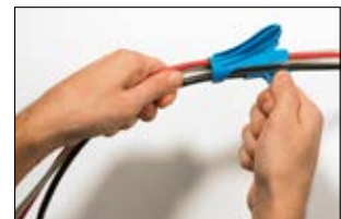
Kabelbündel seitlich in das Aufziehwerkzeug legen.
