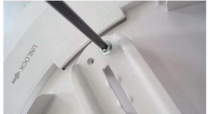
Abb. 2: Trägerplatte an der Rückseite festschrauben
