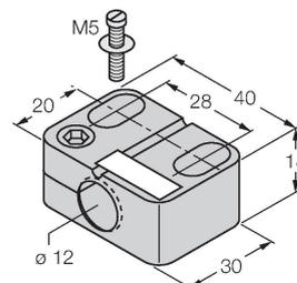
Befestigungsschelle für Gewinderohrsensoren, mit Festanschlag; Werkstoff: PA6
