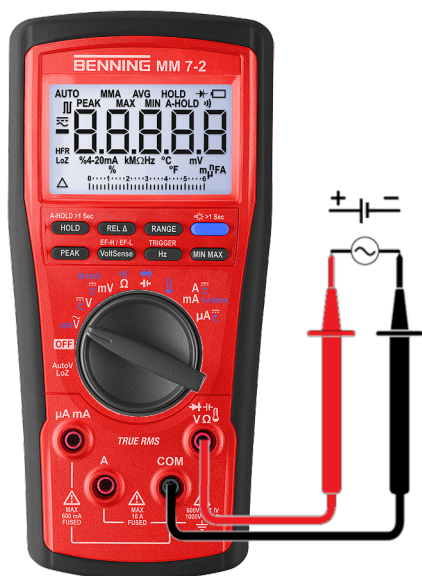
Obrázek 9: Provádění měření napětí, frekvence nebo střidy
