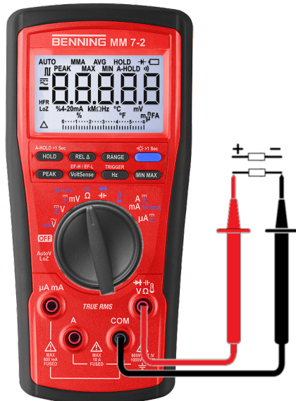
Obrázek 11: Měření odporu nebo zkouška průchodnosti
