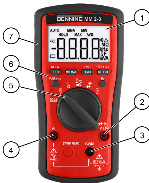
Afbeelding 6: Apparaatopbouw BENNING MM 2-1 / MM 2-2 / MM 2-3
