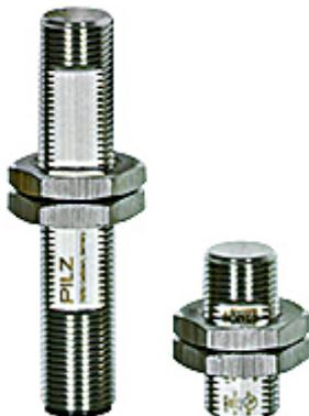
Sicherheitssensor zur Stellungsüberwachung beweglicher Schutzeinrichtungen nach EN 60947-5-3, 2 n/o, 5-pol. M12 Stiftstecker, für Anwendungen bis SIL 3/PL e/Kat. 4, zylindrische Bauform M12, IP69, VP = 1 Sensor mit M12 Betätiger, Schaltabstand 8 mm, Edelstahl Gehäuse.
