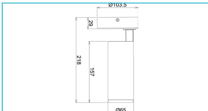
Die dreh- und schwenkbaren Deckenleuchten der LUCEA-Serie sind in den Leistungsstufen 6, 10, 15, 20 und 30 Watt erhältlich. Mit einem Drehwinkel von 350° und einem Schwenkwinkel von 90° können die Leuchten individuell auf Kundenwünsche eingestellt werden. Sie bieten je nach Ausführung bis zu 2.900 Lumen Lichtleistung. Durch den Tausch von optional erhältlichen Linsen, lässt sich der Abstrahlwinkel verengen oder erweitern.
