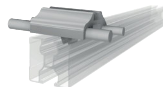
Blitzschutzklemme oben, sehr niedrige Bauhöhe für Module mit Rahmenhöhe 30 mm
