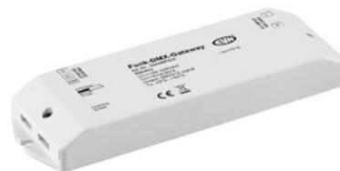
Funk-Controller-Empfänger (DMX-Master) für DMX-Controller. Die Ansteuerung erfolgt über die Funksender (Handsender und Wandpanels) der EFD-Serie mit 868MHz. Sekundär 1x 3-Kanalausgang für den Anschluss der DMX-Controller. Die Schraubklemmen sind für Kabel von 0,5mm<sup>2</sup> - 2,5mm<sup>2</sup> geeignet. Technische Daten: ta: -20°C - 50°C, tc: 75°C.
