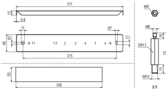
Abdeckung mit Abstandsbolzen für zündfunkenfreie Ex-Potentialausgleichsschiene PAS EX. Mit Anschlussnummerierung und Bezeichnungsschild.
