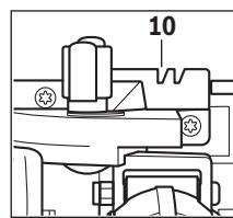
Chỉ sử dụng đánh dấu vết cắt 10 đối với vết cắt vuông góc và vết cắt 45 ° có ray dẫn hướng.
