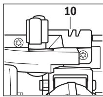
带导轨直角切割和 45° 切割时, 仅使用切割记号 10.
