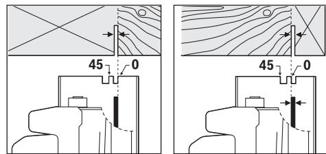
เครื่องหมายตัด 0° 11 แสดงคำแนะนำของใบเลื่อยสำหรับการตัดมุมจาก เครื่องหมายตัด 45° 10 แสดงคำแนะนำของใบเลื่อยสำหรับการตัด 45°
