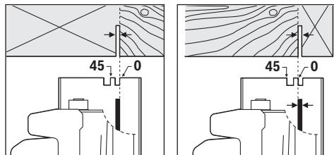
Tanda pemotongan **0°** **11** menunjukkan posisi mata gergaji pada pemotongan dengan sudut siku. Tanda pemotongan **45°** **10** menunjukkan posisi mata gergaji pada pemotongan dengan sudut **45°**.
