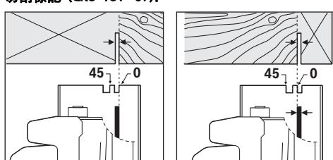
0 度角的鋸割記號 11，標示了直角鋸割時的鋸片位置。45 度角的鋸割記號 10，標示了 45 度角斜鋸時的鋸片位置。
