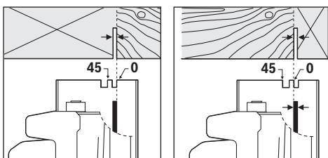
절단 표시 0° 11은 직각 절단을 할 때 톱날의 위치를 나타냅니다. 절단 표시 45° 10은 45° 각도로 절단할 때 톱날의 위치를 나타냅니다.
