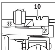
가이드 레일을 이용하여 직각 절단 및 45° 각도로 절단할 경우에는 절단 표시 10만 사용하십시오.
