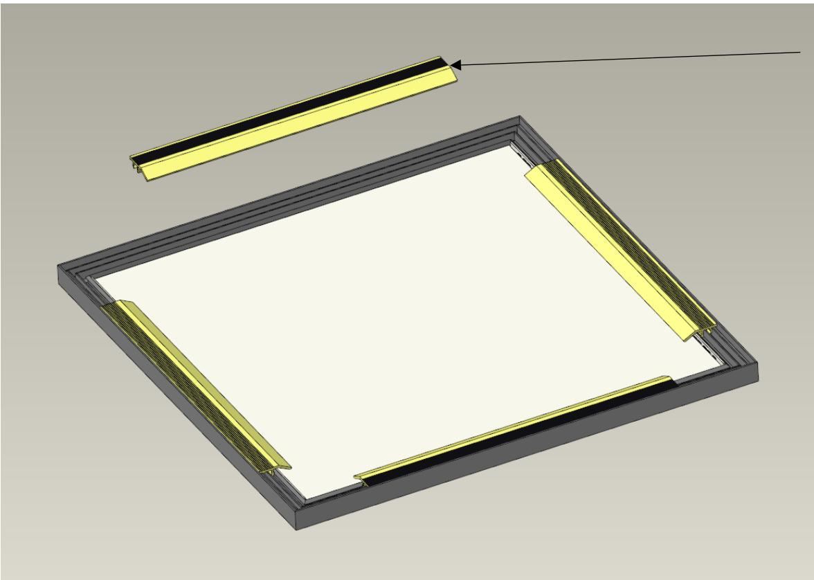
Klemmprofil auf der Leuchtenrückseite ausbauen:
