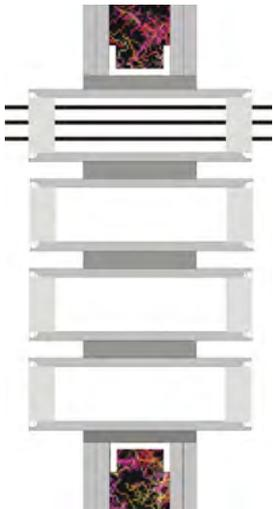
**12.** Gruppen von Boxen in leichten Trennwänden müssen oberhalb und unterhalb durch einen Riegel umfasst werden.
