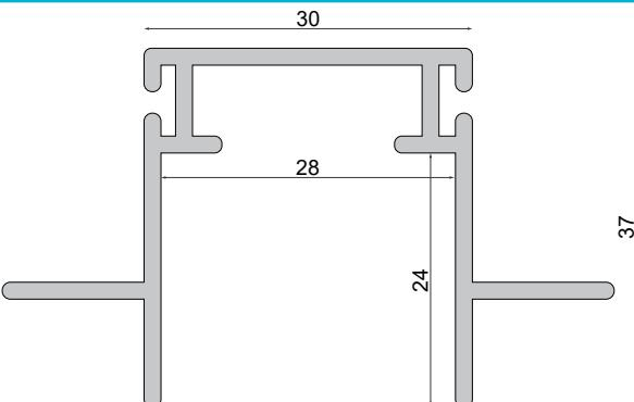
Das patentierte DEKO LIGHT COMBO PROFILSYSTEM ist eine neue, montagefreundliche Profil-in-Profil-Lösung für den Einbau von Lichtlinien in Fassaden, Gärten, Wohnräumen und vielem mehr.
