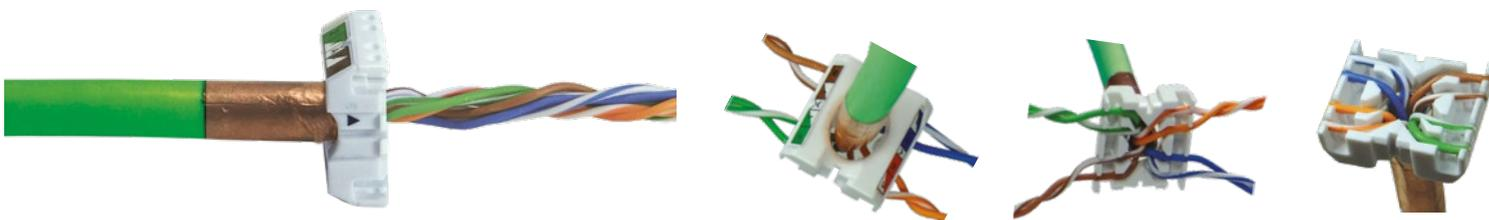
Kabel in Aderanlegekappe platzieren und Adern in die entsprechenden, farblich markierten Kammern ziehen/legen/drücken. Danach überstehende Drahtenden **bündig** abschneiden.
