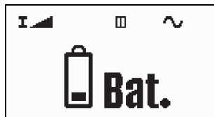
Bild 3.9 Zustand der Batterie nach Drücken von START
