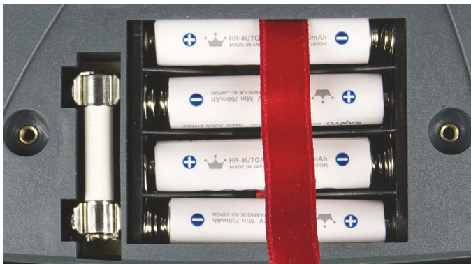
Bild 5 Korrekte Polarität der Zellen
