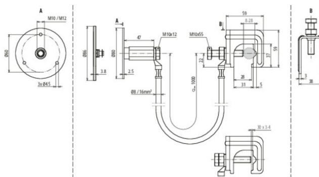
Anschlussgarnitur bestehend aus Verbindungsleitung mit angeschlossener Verbindungsklemme und Erdungsfestpunkt.
