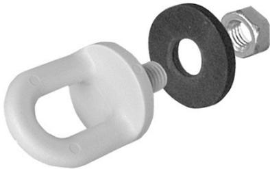
Schrauböse M10x15 aus Kunststoff (Polyamid 6) inklusive Dichtscheibe und SK-Mutter aus Stahl. Zugkraft max. 60N. Anzugs-Drehmoment 2Nm.
