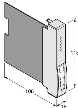
Das analoge Eingabemodul AI43-N dient zum Anschluss von Potenziometern in 3- oder 4-Leiter-Technik. Bei der Verwendung von 3-Leiter-Potenzimetern muss an den Anschlussklemmen am Modulträger eine Brücke gesetzt werden. Widerstandsmessungen, also die Auswertung von Potenziometern mit 2-Leiter-Anschluss, sind nicht möglich.
