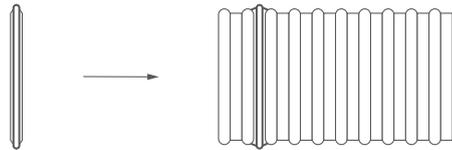
Fixieren Sie anschließend die Klammer über die dafür vorhergesehenen Öffnungen, bis diese einrasten und ein Entfahren der Flexrohre verhindern. Bitte beachten Sie, dass das Rohr bis zum Anschlag in den Anschlussstutzen geschoben wird. Die abgeflachte Seite der Klammern ist immer die Rohrseite.
