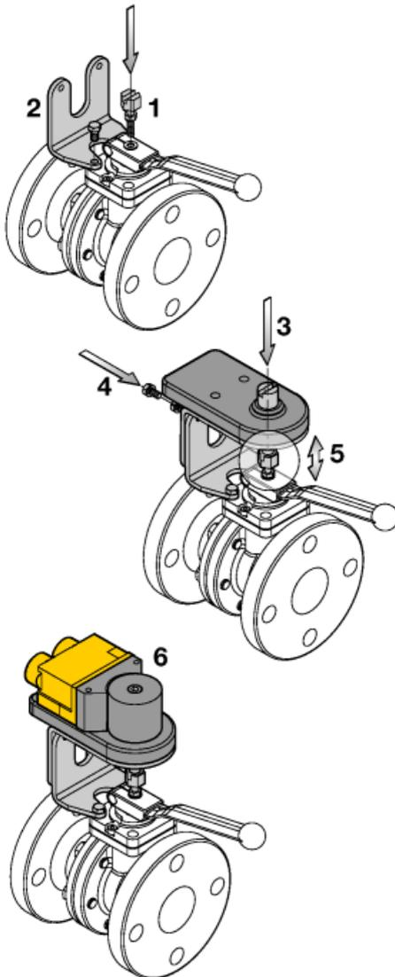
Schrauben Sie die selbstsichernde Mutter auf die Mitnehmerschraube und danach die Mitnehmerschraube in die Handarmatur (1).
