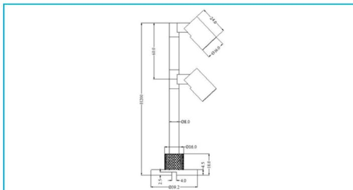
Kleine Helfer, große Wirkung. Mit den HERCULIS Displayleuchten im hochwertigem Aluminiumgehäuse erreichen Sie sämtliche Ecken einer Vitrine. Hierzulässt sich der Leuchtenkopf mit seinem 40° Abstrahlwinkel frei in jede Richtung drehen und schwenken. Zudem ermöglichen die intelligente Kabelführung und das steckfertige System die einfache Auf- und Einbaumontage in Vitrinen, Theken, Verkaufsbereichen oder im Wohnz
