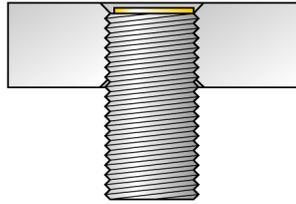
Bei allen bündigen *uprox<sup>+</sup>* Gewinderohrschaltern ist ein überbündiger Einbau erlaubt. Bei einem zurückgesetzten Einbau von 0,5 mm ist ein sicherer Betrieb gewährleistet.
