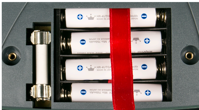
Bild 6.1 Korrekte Polarität der Zellen
