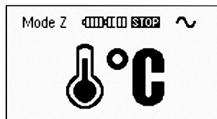
Bild 3.11 Anzeige der Temperaturüberschreitung, nach Drücken der Taste START
