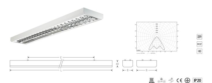
LED Rasterleuchte mit einstellbarer Lichtleistung (MultiLumen), im Auslieferungszustand ist der Maximalwert eingestellt. Stabiler Leuchtenkörper aus Stahlblech weiß, niedrige, zeitlose Bauform. Doppel-Parabol-Raster aus hochglanzpoliertem Aluminium, reduziert Blendungen, UGR 19, so dass an Arbeitsplätzen mit PC-Bildschirmen in Büros, Geschäfts- oder Gesellschaftsräumen für optimale Beleuchtung gesorgt ist. Geeignet zur Montage direkt an der Decke. Zugelassen für den Einsatz in Innenbereichen.
